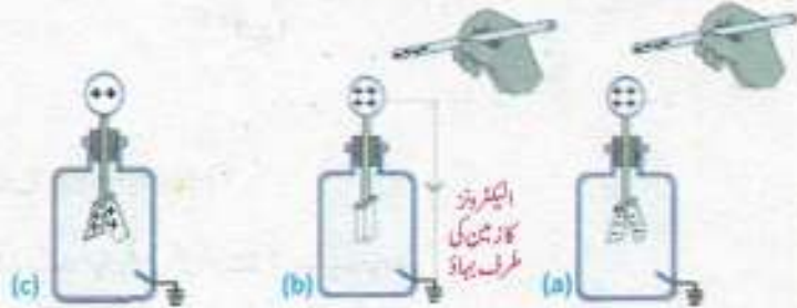
فصل 13.8: الیکٹروسکوپ کو پوزیٹو طور پر چارِج کرنے کا عمل
