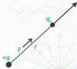
شکل 13.11: ایک چارج +q ، چارج +q_0 سے r فاصلہ پر رکھا گیا ہے
